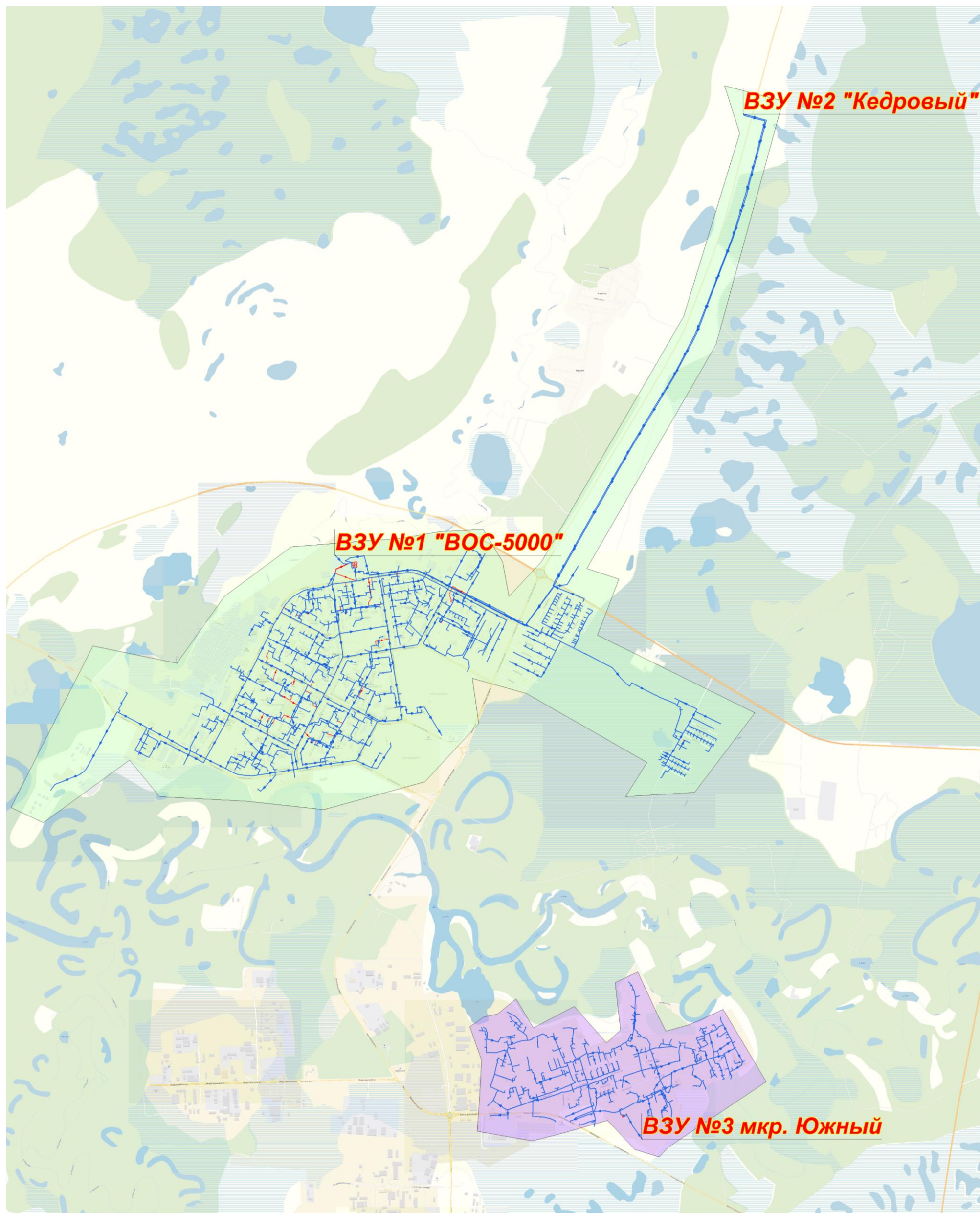
Рисунок 5.4 – Схема планируемого размещения объектов централизованных систем водоснабжения ГО Радужный на 2033 год
